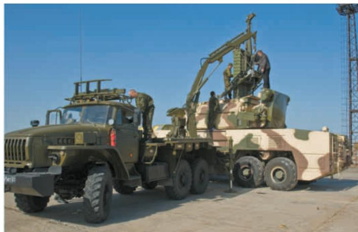
ЗРК «Тор-М2», установка ракетного модуля, almaz-antey.ru
