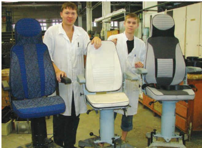
В конце 1990-х годов на заводе начинается освоение локомотивного кресла для машинистов электровозов, тепловозов и дизель-поездов. КЛ-7500 становится единственным в России креслом с механизмом гашения вибраций и гидроударов, обеспечивающим защиту машиниста.
