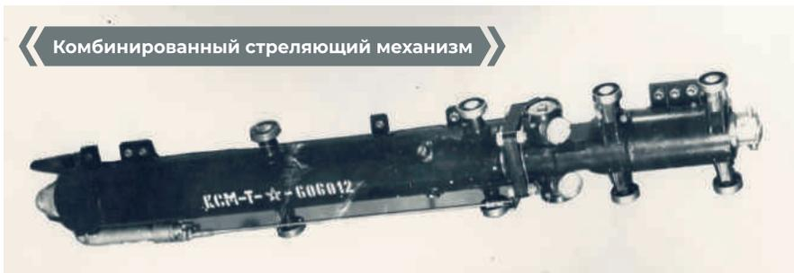
В 1951 году завод № 32 получает задание с грифом «секретно» освоить и изготовить стреляющие механизмы к катапультным креслам конструкции И. И. Микояна – КСМ (комбинированный стреляющий механизм) и ТСМ (телескопический стреляющий механизм) для отечественных самолётостроительных предприятий
