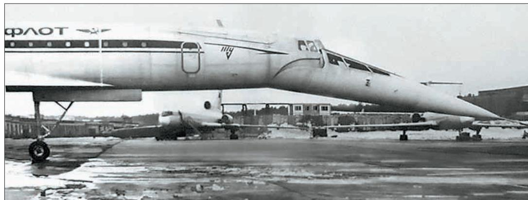
Испытания самолета с укороченной передней стойкой шасси
