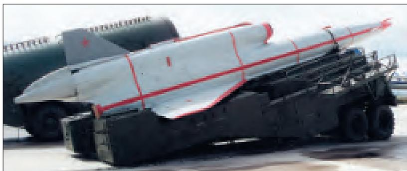
Самолет-разведчик «141» предназначен для ведения комплексной воздушной разведки объектов противника и местности на глубине до 400 км за линию фронта в условиях сильного противодействия ПВО, помех, заражения местности. По составу разведывательного оборудования (аэрофотоаппараты, инфракрасная разведывательная система) он способен выполнять соответствующие виды разведки в любое время суток, с таким типом оборудования самолет выпускался серийно. Но
