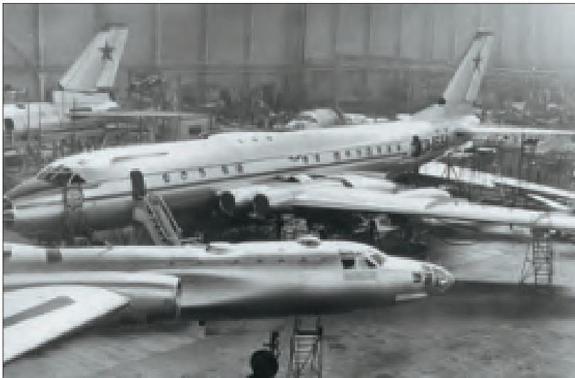
Опытный самолет «110» в конце 1950-х годов был переоборудован под четыре двигателя Д-20П, а затем под Д-20-ПО с системой отбора воздуха
