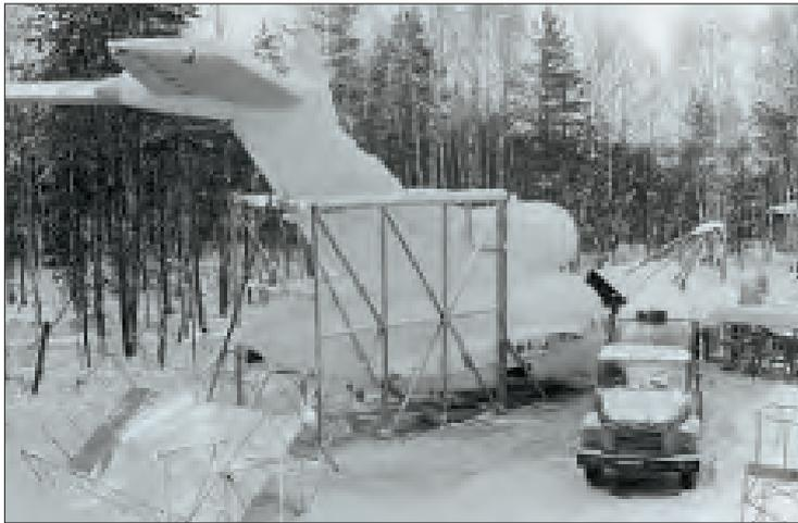
Наземный стенд для отработки подачи криогенного топлива в двигатель
