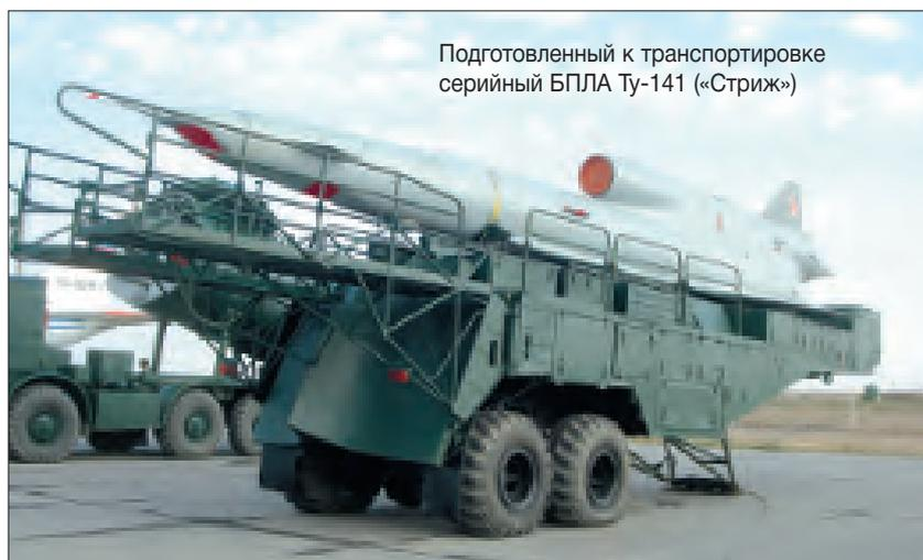
Подготовленный к транспортировке серийный БПЛА Ту-141 («Стриж»)
