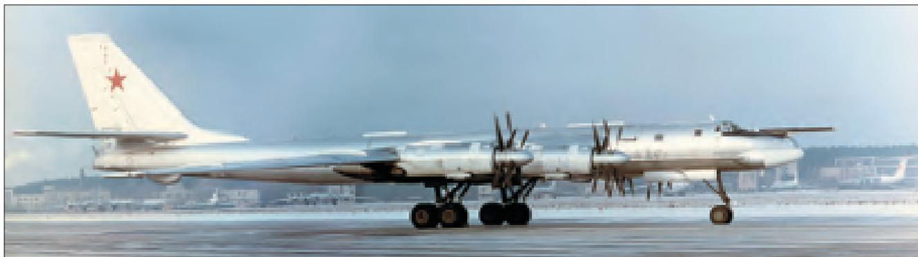
Первый опытный самолет Ту-95МС строился на Таганрогском механическом заводе (ТМЗ) им. Г. Димитрова по документации, подготовленной ОКБ А.Н. Туполева. Для переделки был взят из серии Ту-142МК № 42105. Переоборудование началось во втором квартале 1978 года и закончилось в сентябре 1979 года. В ходе переделки была установлена новая носовая часть фюзеляжа с новой кабиной экипажа и радиолокационной станцией «Обзор-МС», входящей в прицельно-навигационный
