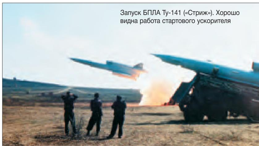
Запуск БПЛА Ту-141 («Стриж»). Хорошо видна работа стартового ускорителя
