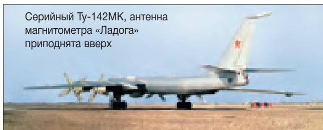
Серийный Ту-142МК, антенна магнитометра «Ладога» приподнята вверх
