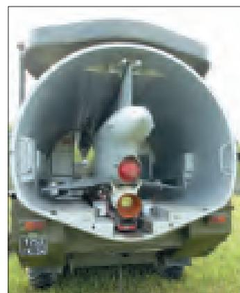
Самоходная пусковая установка СПУ-243 с БПЛА Ту-243 («Рейс-Д»). Транспортно-пусковой контейнер с самолетом поднимается на угол 15 град.
