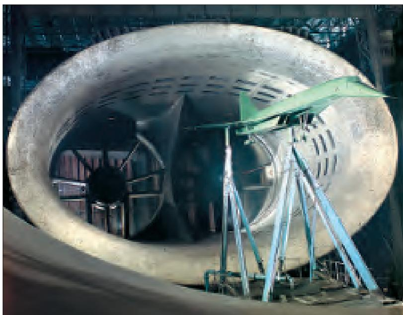
Крыло образовывалось двумя треугольными поверхностями – передней наплывной частью с углом стреловидности по передней кромке в 78 градусов и задней базовой частью с углом в 55 градусов. Крыло имело особую профилировку – была применена пространственная деформация (кривизна) плоскости крыла. Четыре ТРДДФ размещались под крылом. Вертикальное оперение располагалось по продольной оси самолета.
