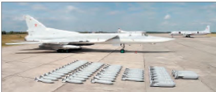
Ударное вооружение самолета Ту-22М3 – крылатые ракеты X-22 и бомбы разных калибров
