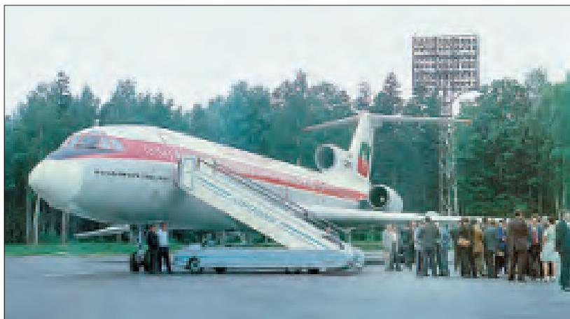
Ту-154А – модификация самолета с установленными в центроплане дополнительными топливными баками, усовершенствованными двигателями НК-8-2У с большей степенью двухконтурности. На самолетах улучшены аэродинамические свойства крыла, взлетная масса доведена до 94 т. Выпущено 63 самолета (бортовые номера с 85056 по 85120)
