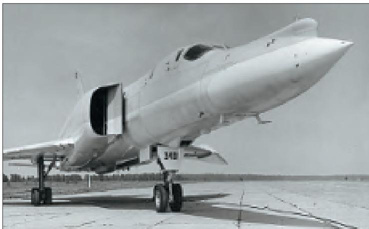
Опытный самолет Ту-22МП – постановщик помех на базе серийного Ту-22М2
