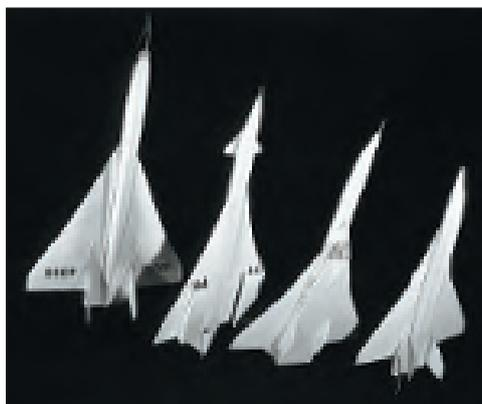
Модели для исследования аэродинамических компоновок
