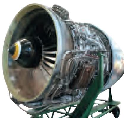
Модернизированный двигатель ПС-90А-2 с пониженной стоимостью жизненного цикла и увеличенным межремонтным и назначенным ресурсами основных деталей, сертифицирован по АП-33
