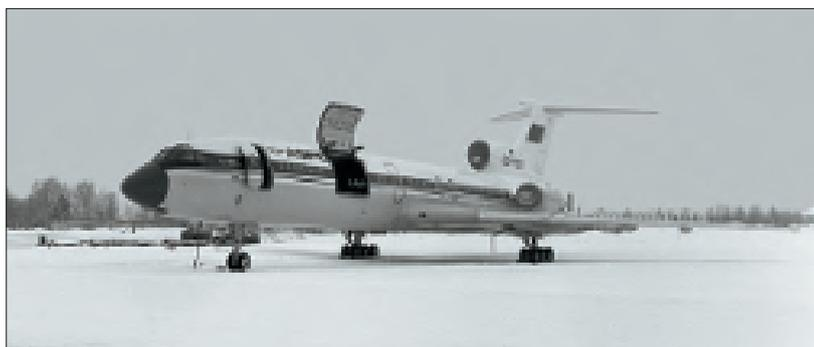
Ту-154М-100 – усовершенствованная версия Ту-154М. Увеличен до 104 тонн взлетный вес. Самолеты оснащались западной авионикой, в том числе обновленной спутниковой системой навигации GPS, и новой РЛС «Контур-10» взамен «Грозы». Всего по заказу Slovak Airlines в 1998 году было поставлено три самолета (бортовые номера 85834, 85835, 85836). Позже самолеты эксплуатировались авиакомпанией «Россия».
