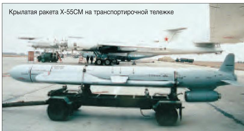
Крылатая ракета Х-55СМ на транспортировочной тележке
