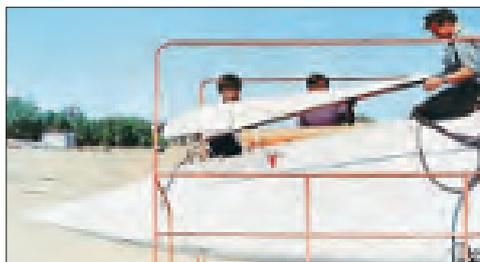
Демонтаж системы дозаправки на самолете Ту-22М2. В зависимости от места обрезки трубы системы по-разному выполнялась зашивка носовой части самолета
