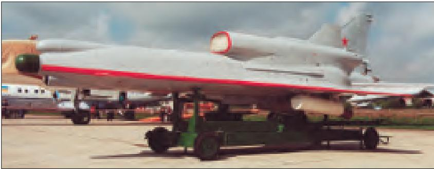
Tu-300 на авиасалоне МАКС, г. Жуковский. Хорошо видны твердотопливные стартовые ускорители
