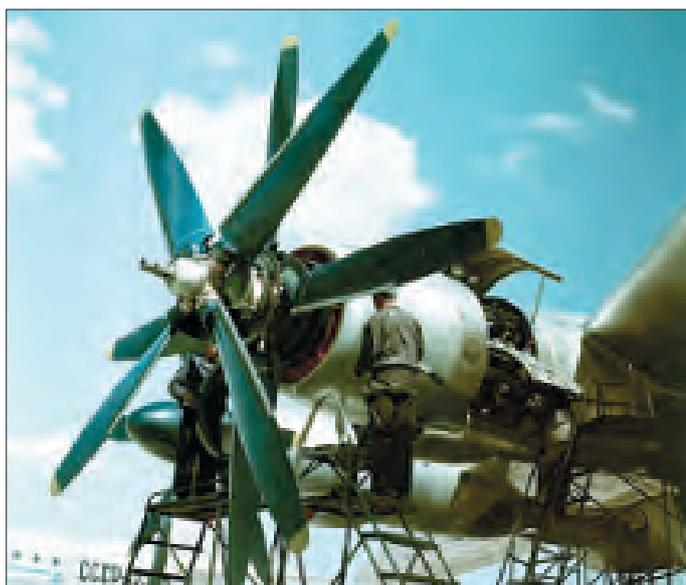
Обслуживание турбовинтового двигателя НК-12МВ
