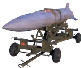
В конце 1980-х гг. отработывалась возможность использования аэробаллистических ракет малой дальности Х-15, Ту-160 мог нести 24 ракеты этого типа
