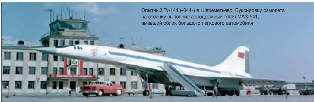
Опытный Ту-144 («044») в Шереметьево. Буксировку самолета на стоянку выполнил аэродромный тягач МАЗ-541, имевший облик большого легкового автомобиля
