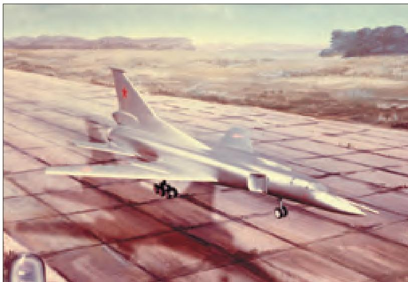
вался как ракетоносец с одной ракетой типа Х-22. Максимальная скорость оговаривалась как 2300–2500 км/ч, дальность полета на дозвуковой скорости с одной ракетой – 7000 км, длины разбега и пробега не должны были превышать 1600 м. Начало совместных государственных испытаний Ту-22М намечалось на второй квартал 1969 года.
