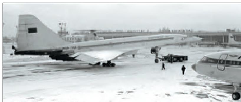
Но 23.05.1978 во время испытательного полета самолета Ту-144Д (б/н 77111) случилась катастрофа, причиной которой стало разрушение топливпровода в двигательном отсеке. После запуска ВСУ возник пожар
