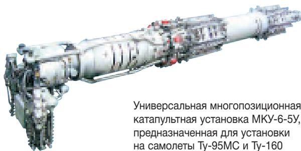
Универсальная многопозиционная катапультная установка МКУ-6-5У, предназначенная для установки на самолеты Ту-95МС и Ту-160
