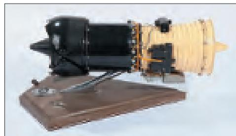
Модель двигателя «61» с реверсивным устройством ковшового типа
