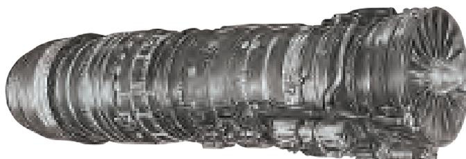
Турбореактивный двухконтурный двигатель НК-25 с форсажной камерой
