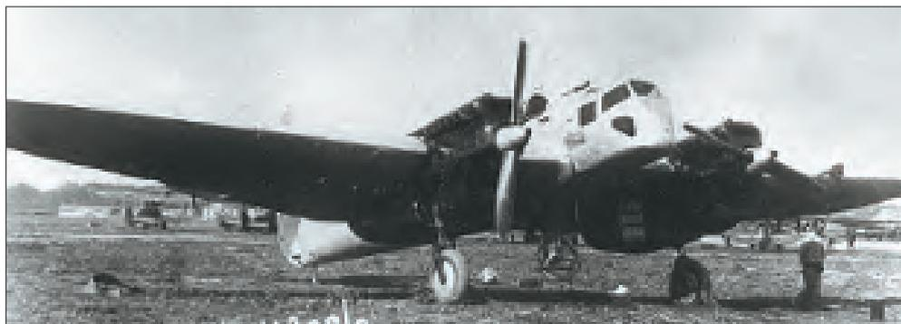
системы оборонительного огня. Кроме того, переднюю пулеметную установку заменили на пушку «Эрликон» калибра 20 мм, установили новые высотные двигатели М-34Н мощностью 830 л.с.
