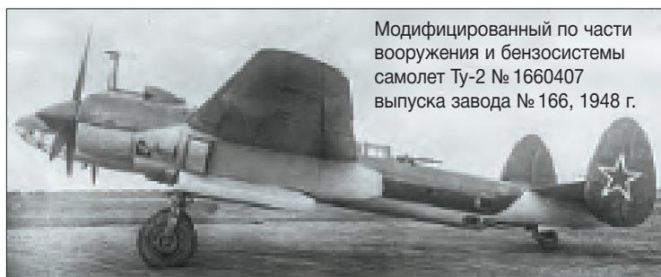
Модифицированный по части вооружения и бензосистемы самолет Ту-2 № 1660407 выпуска завода № 166, 1948 г.
