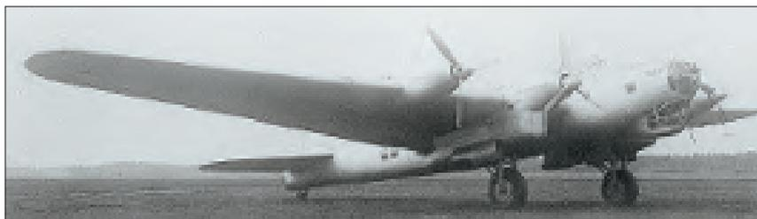
Второй опытный АНТ-42 «дублер» 4 М-34ФРНВ и 1 М-100А в составе АЦН. Совместные испытания, 1938 г.
