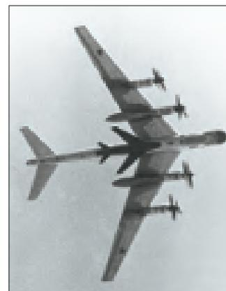
Стратегический ракетоносец Ту-95К с самолетом-снарядом (крылатой ракетой) Х-20М, подвешенным на балочном держателе в грузовом отсеке
