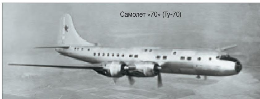
**В** начале 1946 года, когда КБ уже заканчивало основные проектные работы по Б-4 (Ту-4), А.Н.Туполев принимает решение в кратчайшие сроки спроектировать и построить на базе агрегатов самолета Б-4 четырехмоторный пассажирский самолет с герметическими кабинами, который отвечал бы мировым требованиям, предъявляемым к магистральным самолетам того периода.
