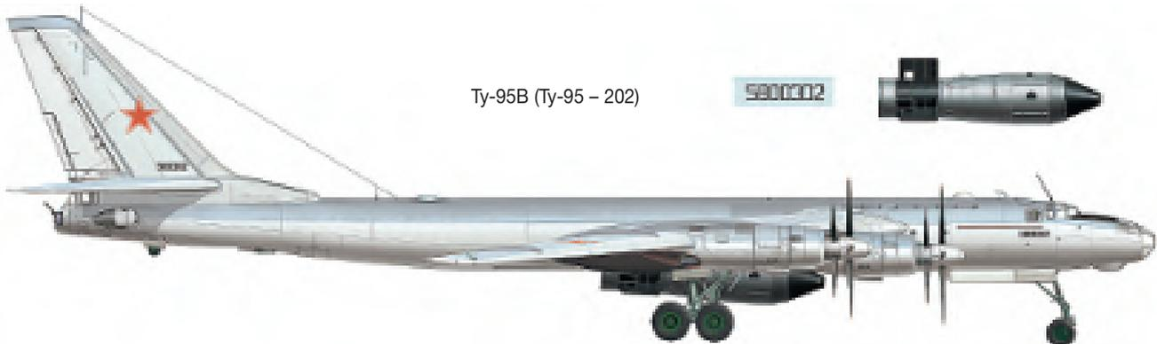
Ту-95 (самолет «В»), серийное воспроизведение второго опытного самолета «95/2» с двигателями НК-12: взлетная масса 172 000 кг, практическая дальность с 5000 кг бомб – 12 100 км, с 1955 по 1958 год был выпущен 31 самолет, в дальнейшем Ту-95 прошли модернизацию (двигатели НК-12М и НК-12МВ, новое оборудование).
