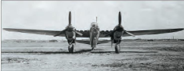
Высотный разведчик-бомбардировщик – самолет «65». Заводские испытания, 1946 г.
