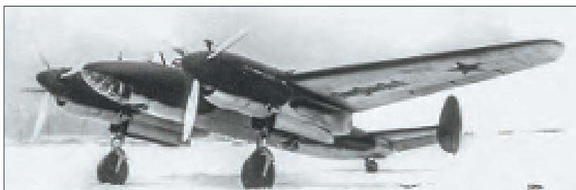
800–900 км/ч. Самолет имел броневую защиту экипажа, мощное и рационально расположенное оборонительное вооружение, протектированные топливные баки, которые заполнялись инертным газом. Все это значительно повышало защищенность и боевую устойчивость самолета «103», что отличало его в лучшую сторону от других отечественных фронтовых бомбардировщиков того периода.
