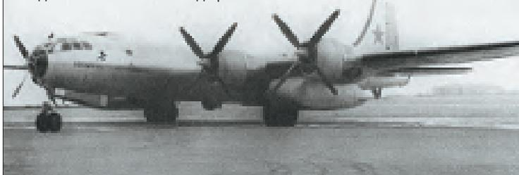
Ту-4Т – опытный транспортно-десантный самолет (переоборудованный Ту-4 с/н 2806202) с грузовыми подвесными кабинами. В отличие от Ту-4Д вооружение оставлено только в кормовой кабине
