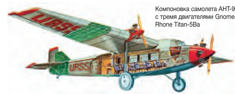
Компоновка самолета АНТ-9 с тремя двигателями Gnome-Rhone Titan-5Ba
