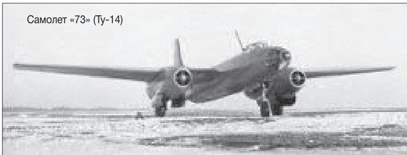
В январе 1947 года в КБ начались работы по созданию нового реактивного ближнего (фронтового) бомбардировщика с герметическими кабинами под два ТРД Rolls-Royce Nene I («Нин-1»), получившего по КБ обозначение самолет «73», официальное – Ту-20 2 «Нин-1».
