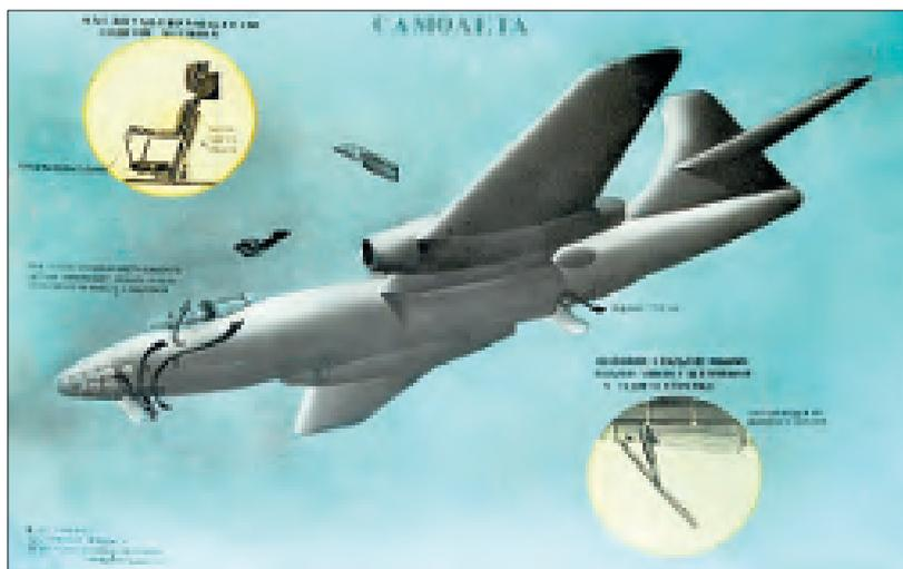
Схема аварийного покидания самолета «73»
