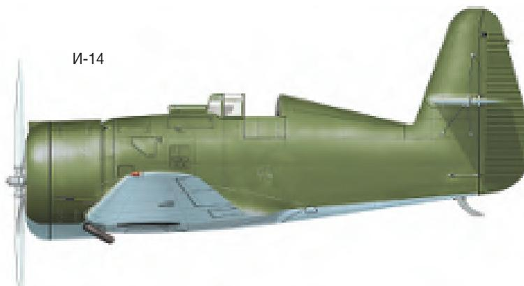
обозначение АНТ-31, официальное – И-14, назначили П.О. Сухого. Самолет задумывался как пушечный с динамо-реактивными пушками. Большие сложности возникли при подборе подходящего двигателя для самолета. Для первой опытной машины остановились на английском высотном двигателе Bristol Mercury IV воздушного охлаждения с максимальной мощностью 540 л.с.
