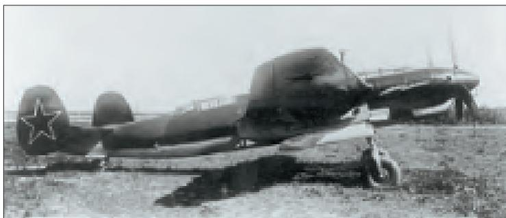
Первый экземпляр скоростного дневного бомбардировщика – самолет «63/1» (на базе самолета «103»), 1944 г.
