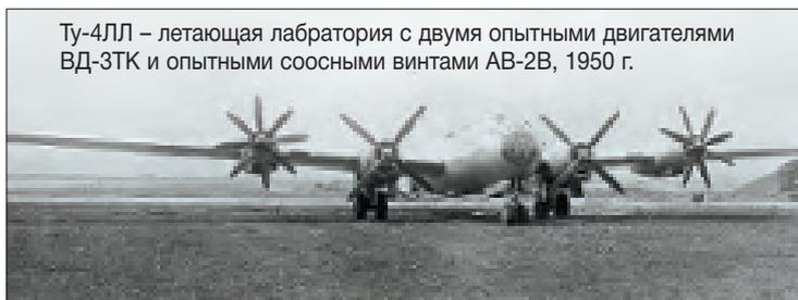
Ту-4ЛЛ – летающая лаборатория с двумя опытными двигателями ВД-3ТК и опытными соосными винтами АВ-2В, 1950 г.
