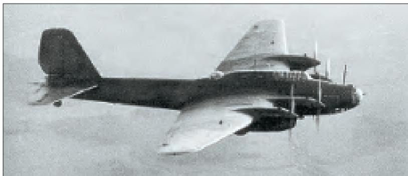
Пе-8 с дизельными моторами АЧ-30Б (более совершенные по сравнению с дизелями М-30, устанавливались в 1944 г.)
