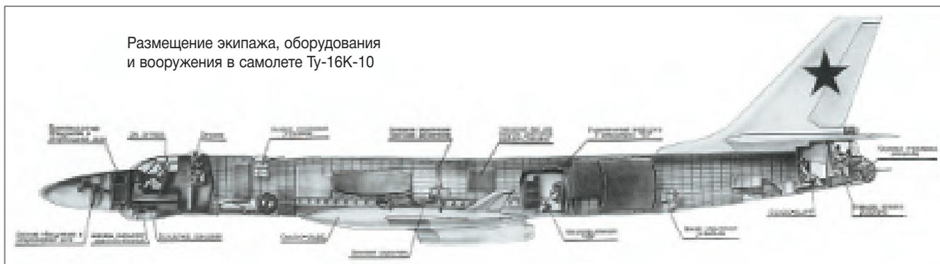
Размещение экипажа, оборудования и вооружения в самолете Ту-16К-10
