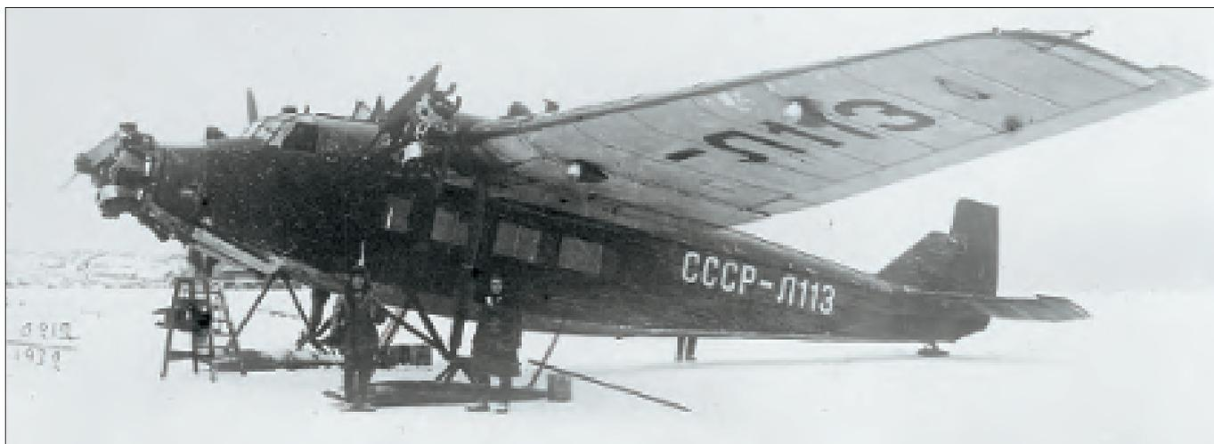
АНТ-9 (ПС-9) СССР – Л113 с двигателями М-26 на лыжном шасси. Эксплуатировался в «Добролете» (с 1932 г. – в «Аэрофлоте»). Позже был передан в НИИ ГВФ и переоборудован под два двигателя М-17, став прототипом двухдвигательного варианта АНТ-9. 18.10.1932 совершил перелет Москва – Киев
