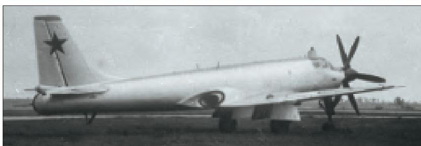
рого учитывались как полученный опыт при испытаниях опытного самолета «91», так и требования массового серийного производства. Основные отличия «дублера» (самолет «91Д») от первого опытного самолета «91» были следующие: расширен обвод фюзеляжа в носовой части на 35 мм на каждую сторону; выдвинуты вперед на 300 мм и закреплены на крыле
