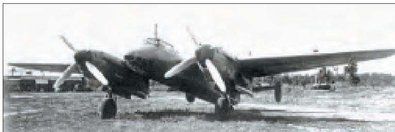
Модернизированный самолет «68» с двигателями АМ-39ФНВ2 с флюгерными винтами, заводские испытания, 1946 г.
