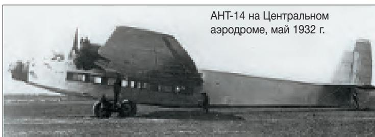
Подобный подход к проектированию пассажирских самолетов стал основополагающим для ОКБ А.Н.Туполева: сначала самолет военного назначения, а затем на базе его агрегатов и проверенных в ходе его создания и эксплуатации технических решений – пассажирский самолет. Такой подход использовался до начала 1960-х годов, обеспечивая высокие темпы проектирования, освоения в серии и в эксплуатации пассажирских машин.
