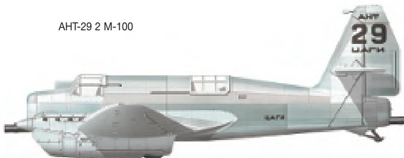
Самолет проектировался «вокруг» пушки. Пушка АПК-8 калибра 102 мм и длиной 4 м выступала за передний обвод фюзеляжа, а ее труба для отвода газов заканчивалась за рулем направления. Помимо ДРП в центроплане крыла устанавливались два пулемета и один турельный пулемет у стрелка-наблюдателя. Для АНТ-29 была принята схема двухдвигательного свободнонесущего низкоплана цельнометаллической конструкции с гладкой обшивкой
