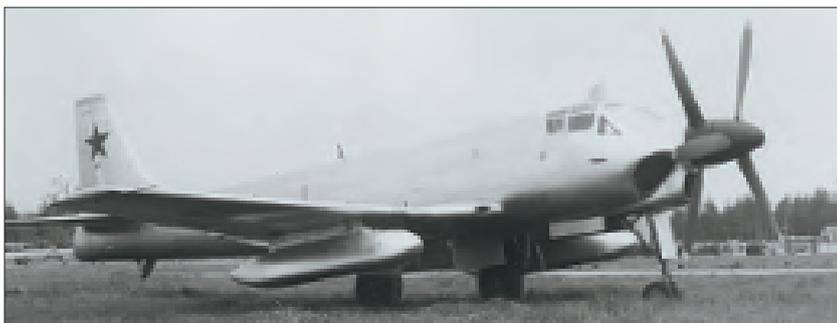
Самолет «91» (Ту-91) с двумя подвесными универсальными контейнерами под крылом. В контейнерах размещались пусковые блоки с ракетными снарядами
