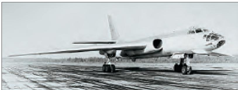
23.06.1954 вышло Постановление Совета Министров СССР № 1249-558 и на основании его – Приказ МАП № 408 от 29.06.1954 о создании на базе серийного самолета Ту-16 самолета-разведчика Ту-16Р с двумя модернизированными двигателями АМ-3М-200 (РД-3М) с максимальной взлетной тягой 9500 кг, дальностью полета 6000–6200 км. Срок передачи опытного разведчика на государственные испытания был определен мартом 1955 года.
