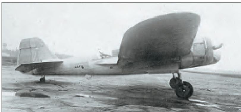
Модернизированный СБ 2 М-100А, государственные испытания, 1937 г. Кабина стрелка-радиста полностью переоборудована: смонтирована ТУР МВ-1 – экранированная пулеметная установка, серийная люковая стрелковая система заменена на пулеметную установку конструкции Веневидова и Можаровского
