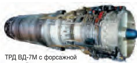
ТРД ВД-7М с форсажной камерой и регулируемым соплом
