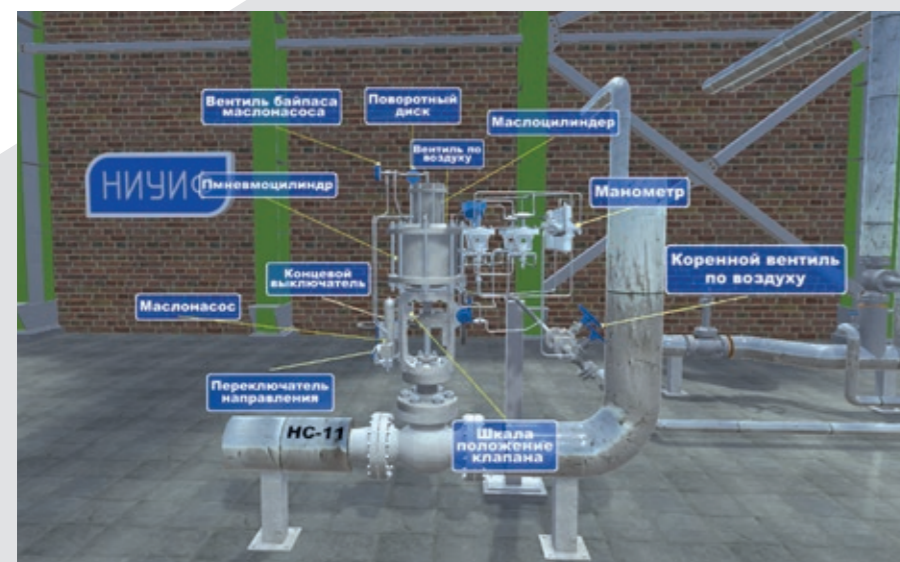
Регулирующий клапан с подведенными участками трубопровода цеха АМ-1
